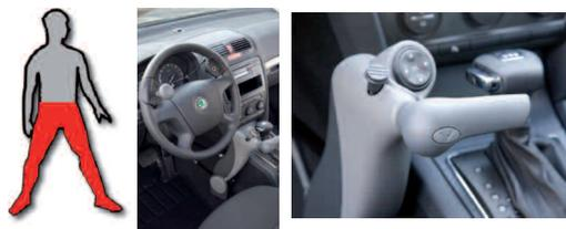
Zum Gasgeben wird der ergonomisch geformte Handgriff in Uhrzeigerichtung gedreht. Ein leichter Druck nach vorne aktiviert die Bremse.
